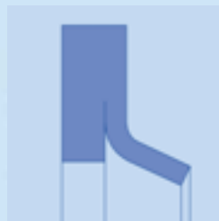
EMHX – Guarnizione dello stelo | Paraolio | Guarnizione radiale Guarnizione a cappello con guida integrata.
