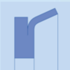
EMTX – Guarnizione del cilindro Guarnizione a tazza con guida integrata.
